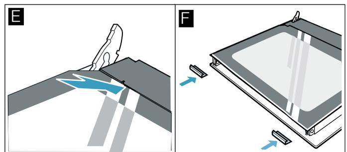
7. Die Abdeckung aufsetzen und anschrauben.
