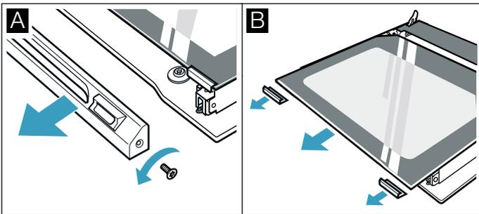
4. Die Halteklammern rechts und links entfernen. Die Scheibe anheben und die Klauen von der Scheibe entfernen (Bild C).
