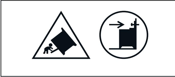
**Warnung:** Um ein Umkippen des Gerätes zu vermeiden, muss dieses Stabilisierungsmittel montiert werden. Für die Montage siehe Anweisungen.
