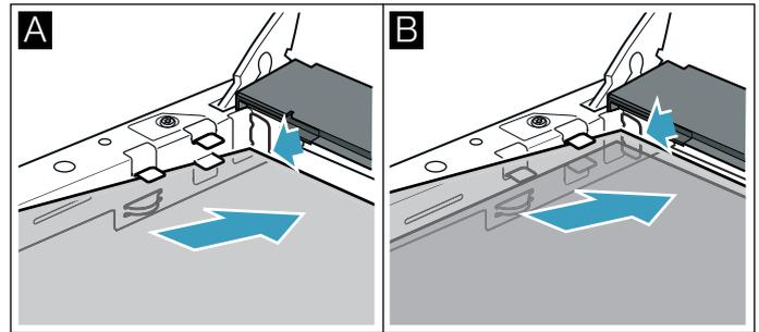
3. Die Halteklammern rechts und links auf die Scheibe stecken und so ausrichten, dass die Federn über dem Schraubloch sind. Die Halteklammern festschrauben (Bild C).
